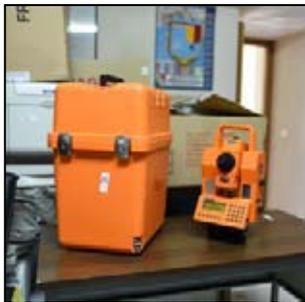
teodolite marca GEODIMETER tipo GD-M608M571202005 n serie 60910198 completo di confezione e batteria di ricambio
